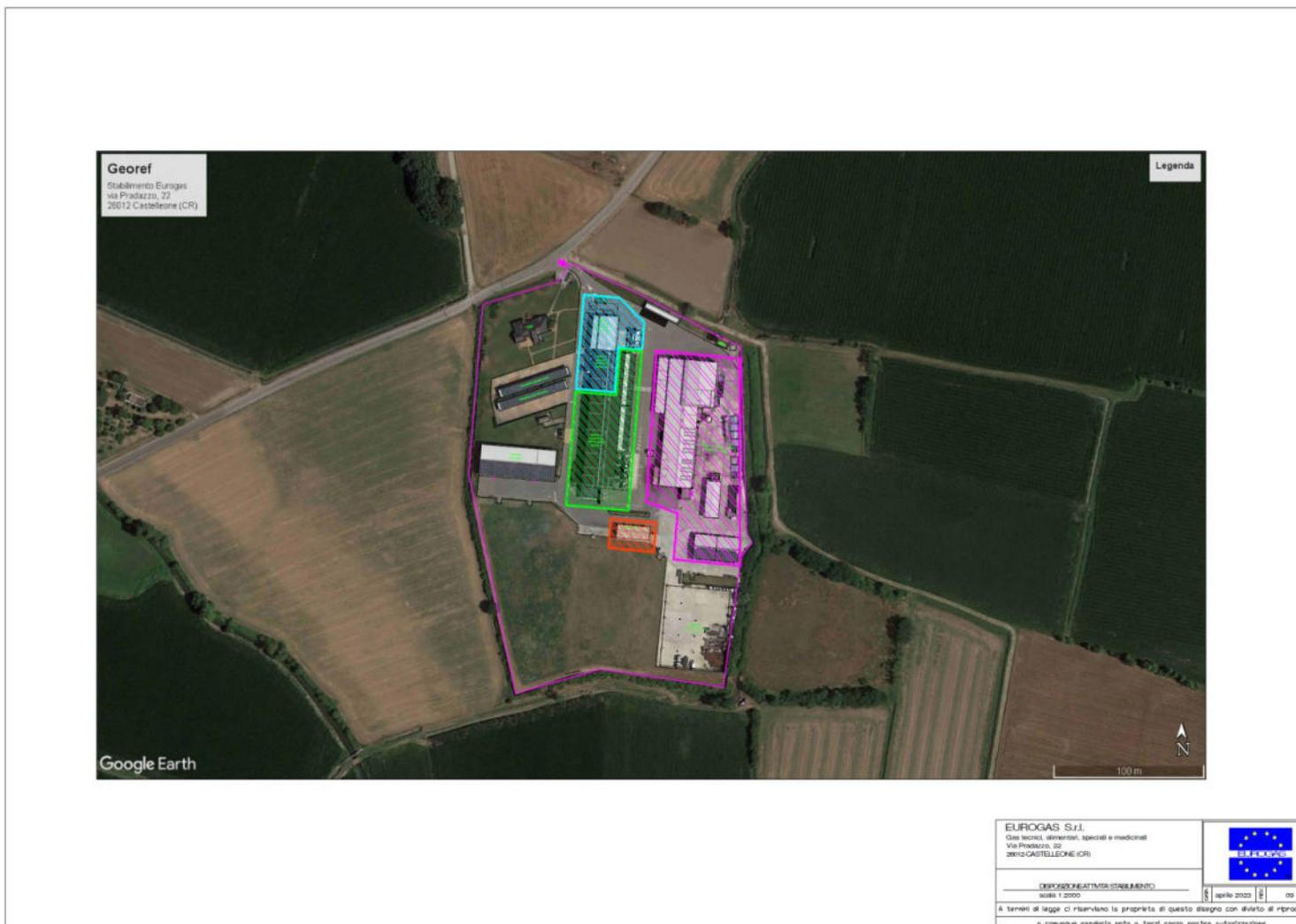
Figura 2.1.1 – Organizzazione insediamento Eurogas S.r.l. (in azzurro: impianto produzione protossido d'azoto; in verde: impianto riempimento gas e miscele tecniche; in magenta: impianto produzione acetilene ed idrossido di calcio; in rosso: deposito GPL).
